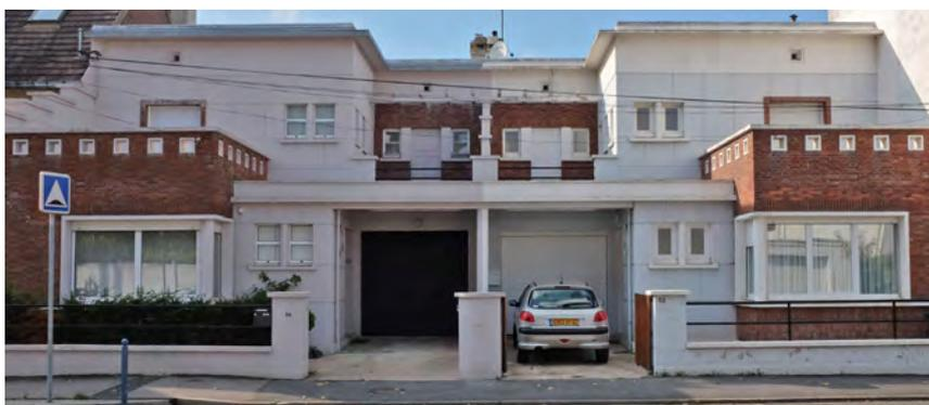
Dans cette architecture moderniste, la brique est utilisée pour souligner le jeu des volumes et détacher les «cubes» en béton .
