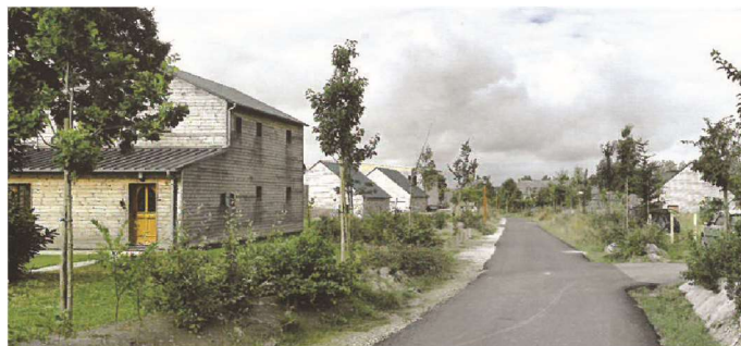
Une voirie poreuse et à sens unique qui favorise l'infiltration des eaux et limite la circulation tout en assurant le maillage du village,
