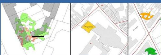
De gauche à droite : différence d'échelle entre cavité du BRGM et de la ville, position géographique incongrue de la cavité BRGM, discordance de position de la même cavité entre ville et BRGM.
