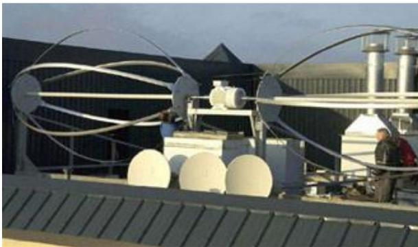
Eolienne de type Darrieus à axe horizontal en toiture à Equihen en France (puissance : 6 kW)
