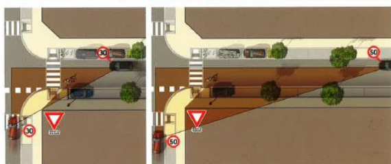
Dans ce contexte contraint, l'apaisement de la vitesse a été traité en amont du carrefour. La réduction de largeur de chaussée a permis de gérer le seuil d'un restaurant et l'attente du bus tout en proposant un cheminement confortable pour les scolaires.
