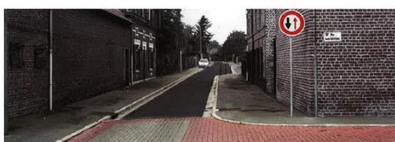
Dans le cas de ce carrefour plus étroit, la création d'un trottoir et le traitement en plateau permettent de retrouver une continuité du cheminement piéton en accord avec la loi accessibilité. La présence d'une écluse s'appuie de manière très logique sur l'avancée du bâti.
