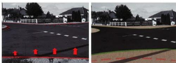
La réduction de largeur de chaussée et l'ajustement des rayons de giration sont des moyens efficaces pour inciter à une circulation apaisée et permettre des traversées piétonnes plus courtes et sécurisées.
