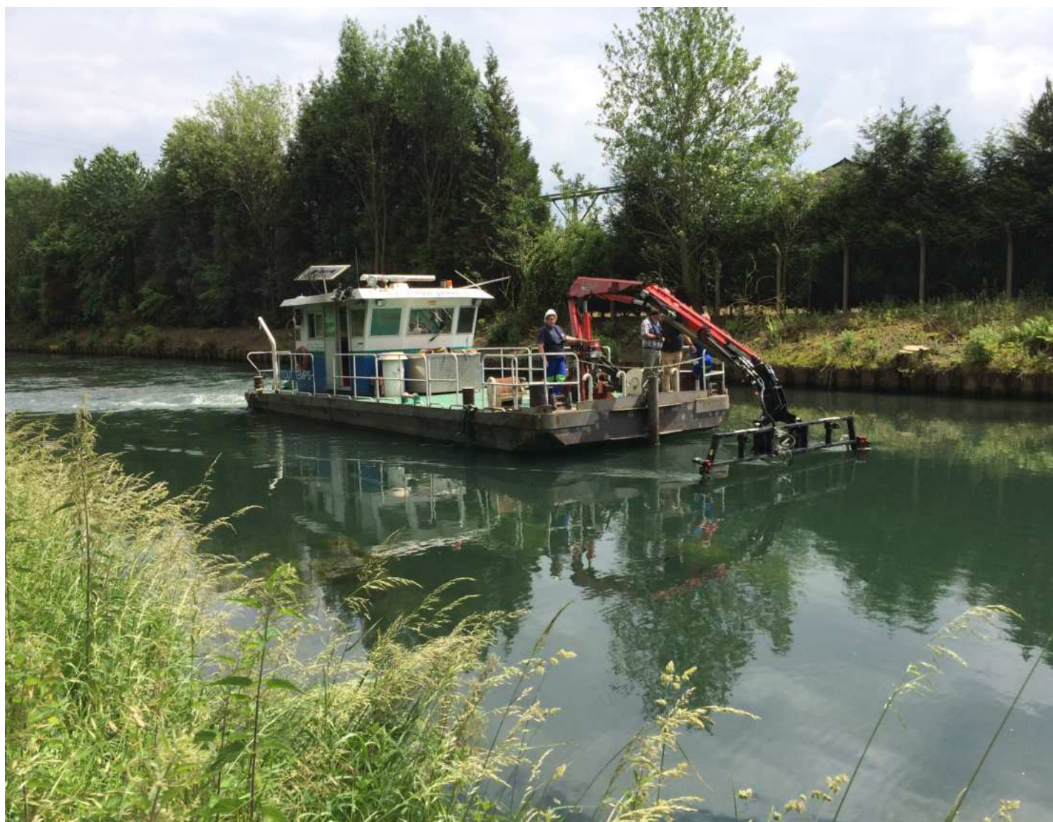
© CUA - Faucardage de la Scarpe canalisée
