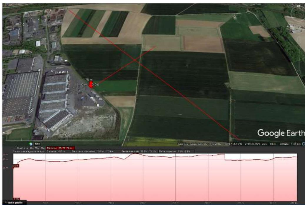
***La topographie entre en compte pour la gestion des eaux de ruissellement où il faudra intégrer les pentes et les points bas afin de créer des espaces d'infiltration. Elle entre également en compte pour l'insertion du bâti.***
