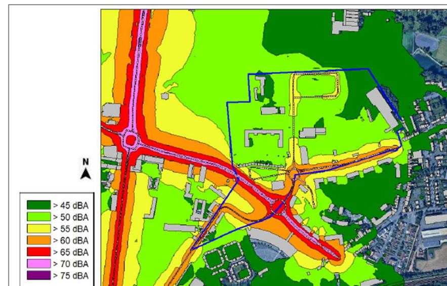
Figure 24: Cartographie sonore en dBA à 4m au-dessus du sol-Etat initial-Période 6h-22h
